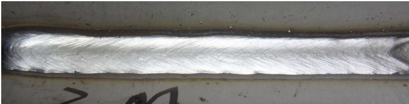
80%Ar+20%CO2 угловое соединение 220А/30V
