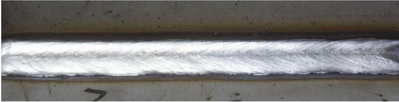
100%CO2 угловое соединение 220А/32V
