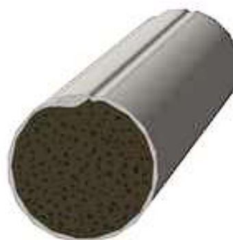
Рис. 1. Конструкция присадочного прутка с флюсовым сердечником: стальная оболочка заключает в себя флюсовый наполнитель
